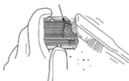
2. Установите искрогаситель в порядке, обратном снятию. При установке искрогасителя его выходная часть должна быть направлена в противоположную сторону от свечи зажигания.
