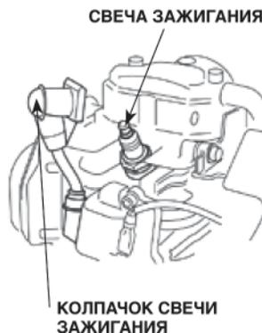
7. При установке новой свечи зажигания затяните ее еще на полоборота, когда свеча сядет на место, чтобы сжать уплотнительную шайбу.
